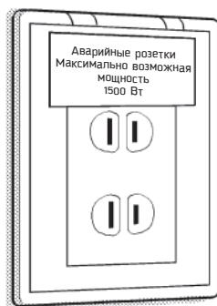
Рис. 5.7. Аварийные розетки на стене
