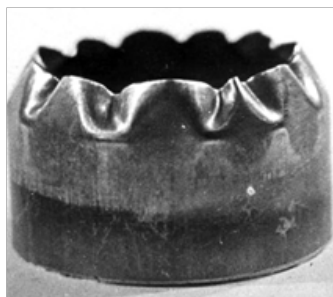
Рис. 3.42. Потеря устойчивости краевой части заготовки в начальной стадии обжима
