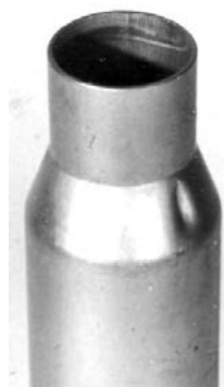
Рис. 3.43. Образование продольной складки при обжиме
