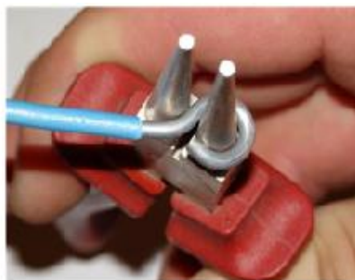
Рис. 2.2. Формовки колечка с применением круглогубцев
