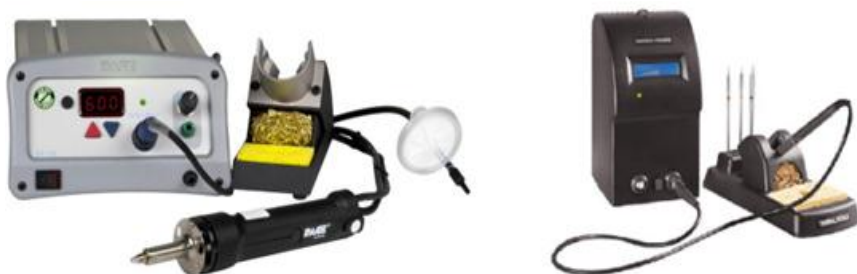
Рис. 12. Паяльные станции с регулируемой и стабилизированной температурой жала паяльника
