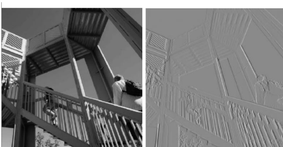
Рисунок 4.6 – Пример применения ядра, которое выделяет вертикальные линии
