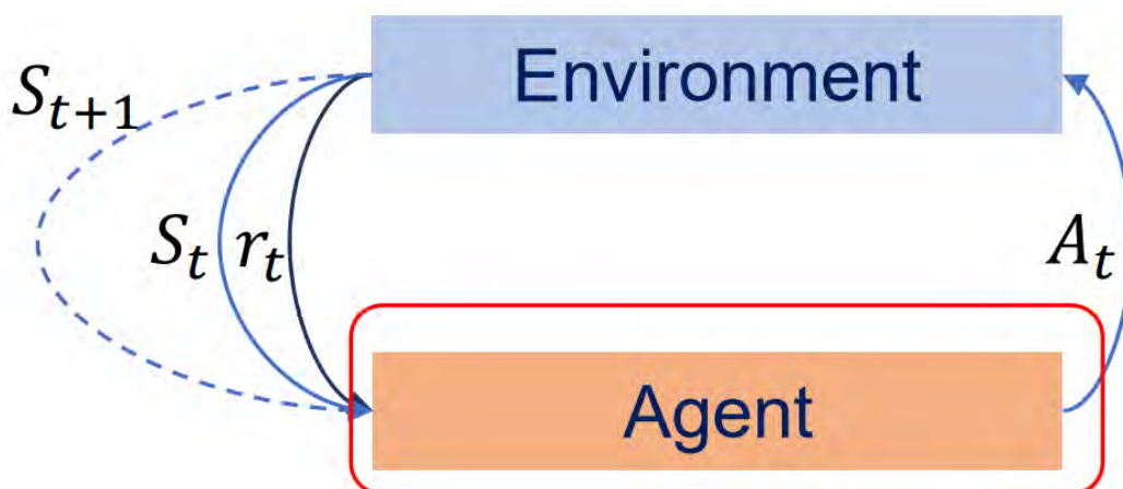
Рисунок 3.9 – Схематичное представление обучения с подкреплением. Environment – Среда; Agent – Система управления «Агент»
