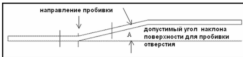
Рис. 4.14. Допустимый угол наклона поверхности для пробивки отверстия
