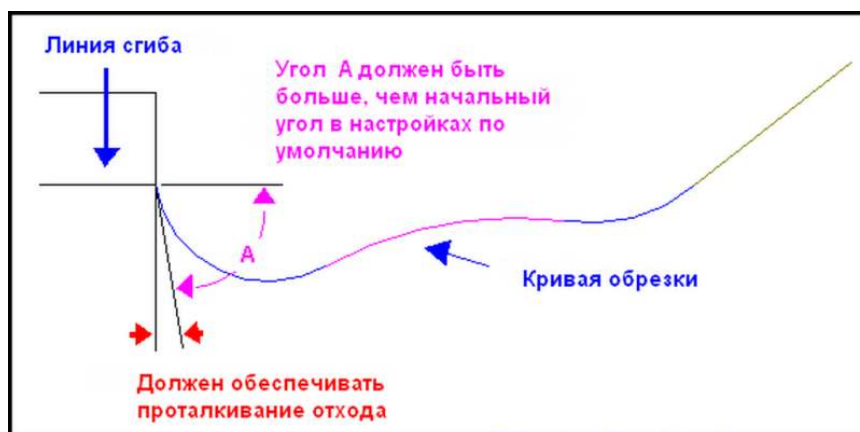
Рис. 4.8. Обрезка освобождений. Контроль угла обрезки
