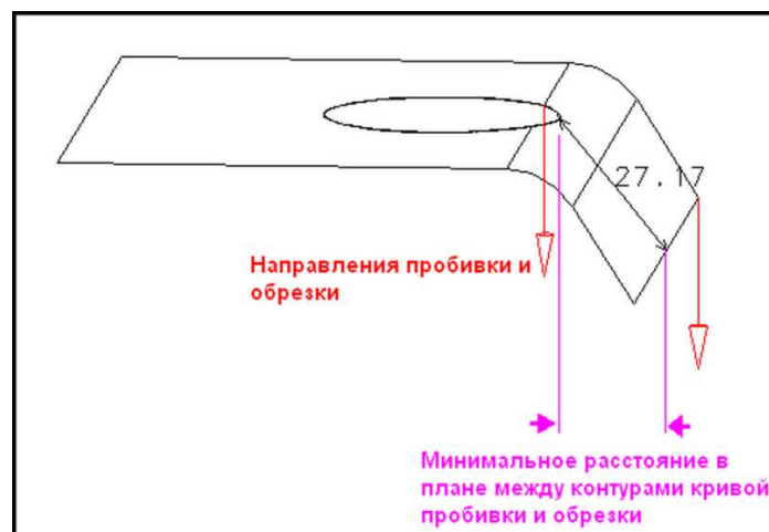
Рис. 4.11. Геометрические параметры критерия Обрезки от обрезки
