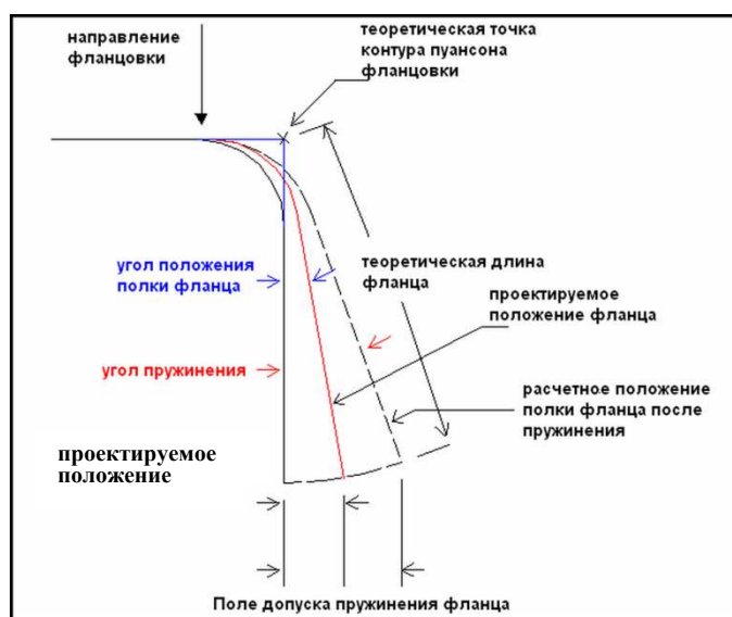
Рис. 4.31. Пружинение фланца
