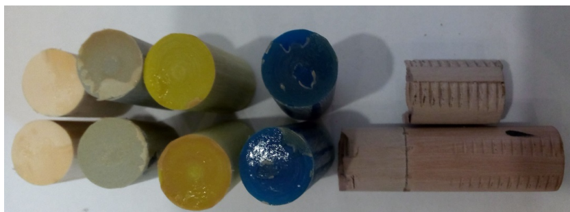
Рис. 5.6. Внешний вид одной из группы образцов пластик/пластик, склеенных клеем UR 3569
