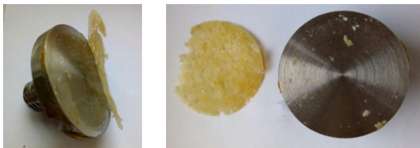
Рис. 6.18. Вид образца с отслоившимся от подложки адгезивом
