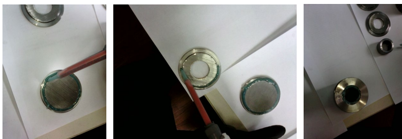
Рис. 4.8. Поэтапный процесс склеивания фильтра
