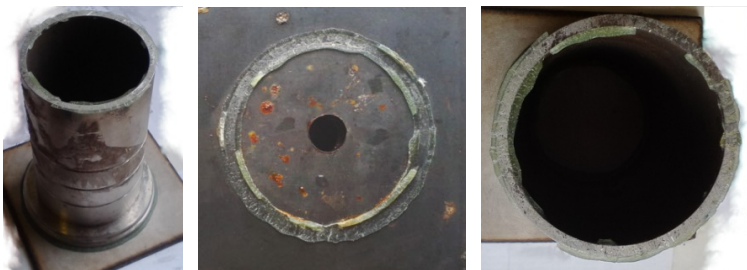
Рис. 4.11. Испытательный макет и крышка макета после гидравлических испытаний
